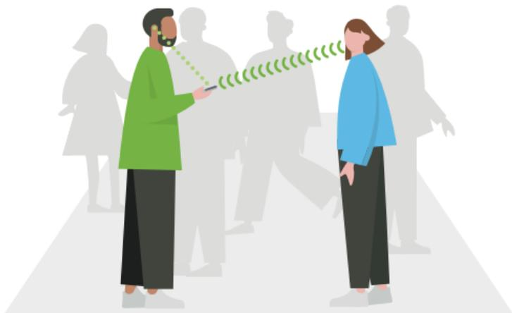
El micrófono activará automáticamente un haz estrecho y capta la voz de la persona a la que está apuntando. Se indica con un triángulo en la pantalla.
