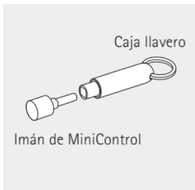
Con el audífono encendido, sostenga el imán dentro del conducto auditivo sin tocar el audífono. Retire inmediatamente el imán en cuanto que el Virto P-Titanium o Virto P-10 NW O esté en el programa deseado o el volumen sea el adecuado.
