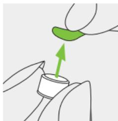
**1.** Retire el plástico protector de la pila nueva y espere dos minutos.
