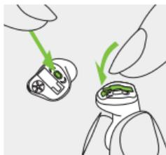
Para activar el modo avión, pulse el botón pulsador durante 7 segundos a la vez que cierra la tapa del portapilas. Para desactivar el modo avión, simplemente abra y cierre la tapa del portapilas de nuevo.
