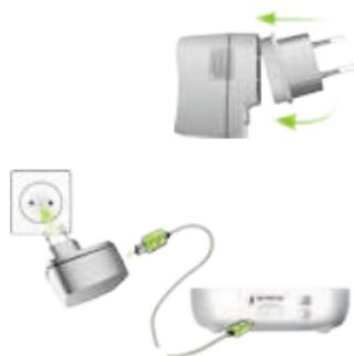
Al completarse la carga (se muestra una luz verde fija), desconecte la fuente de alimentación de la red eléctrica y el cable USB del micrófono.
