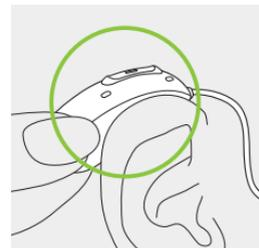
2. Inserte el adaptador protésico en el conducto auditivo.
